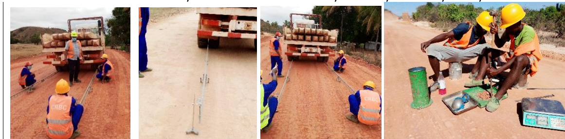
Figure 1: Mesure de déflexions et vérification des épaisseurs de couche de fondation au PK 54+200 Ambilobe Madagascar.
