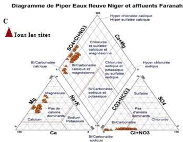
Figure 6 : le diagramme de Piper montre le degré de minéralisation des eaux. C = le degré de minéralisation de l'ensemble des eaux analysées (tous les sites). CP_CV = Centre-Ville, CP-S =Cours Principal Source.
